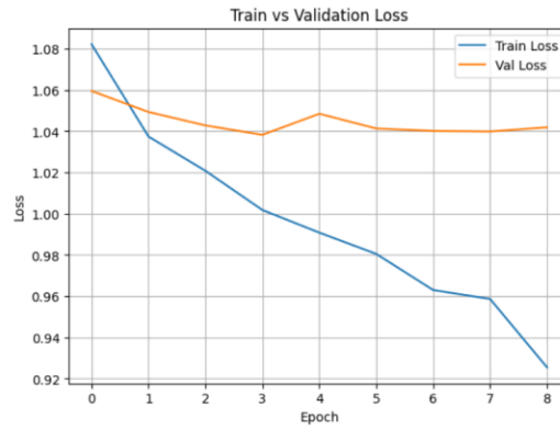
Figura 5.9 Kurba e humbjes gjatë trajnimit dhe validimit – BiLSTM + Attention + MFCC
