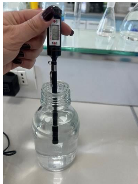
Figura 2.18 Termometër uji portativ i përdorur për matjen in situ të temperaturës të ujërave liqenore dhe detare në zonat e Pogradec dhe Sarandë
