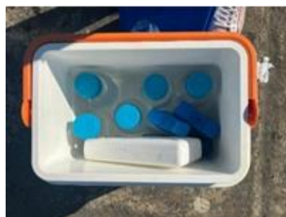
Figura 2.19. Termoboksi i përdorur për transportin dhe ruajtjen e mostrave të ujit në kushte të kontrolluara temperature gjatë transferimit nga terreni në laborator.
