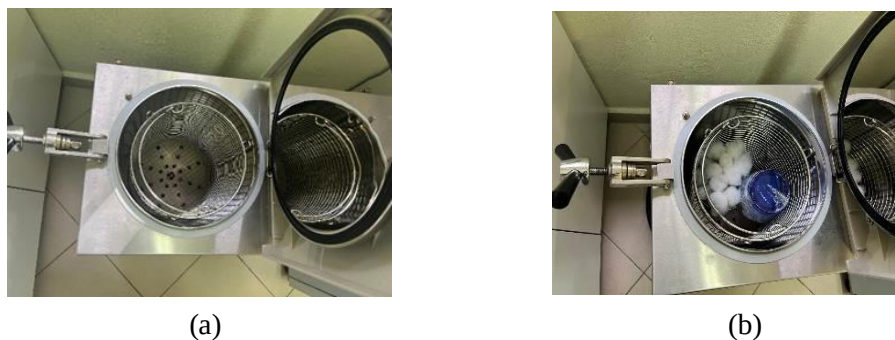
Figura 2.16 Autoklavë për sterilizimin e shisheve të mostrave (500 mL) në 121 °C.
