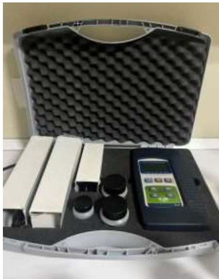
Figura 2.15. Foto e paisjes Aqualytic AL 15 për matje direkt në vendin e kampionimit (O.Luka)
