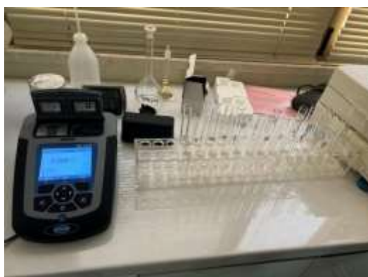
Figura 2.19. Spektrofotometri i përdorur për matjen e nitriteve (O.Luka)
