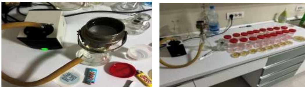
Figura 1.2. Metoda me filtrin membranorë për analizën mikrobiologjike të ujit (O.Luka)
