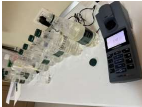
Figura 2.16. Foto e paisjes TURB 430IR për matjen e turbiditet (O.Luka)
